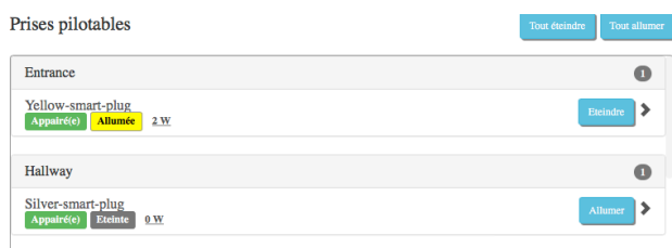
Figure 4: Extrait du panneau de contrôle des prises pilotables montrant leur état, la consommation instantanée et les actions utilisateur possibles.
